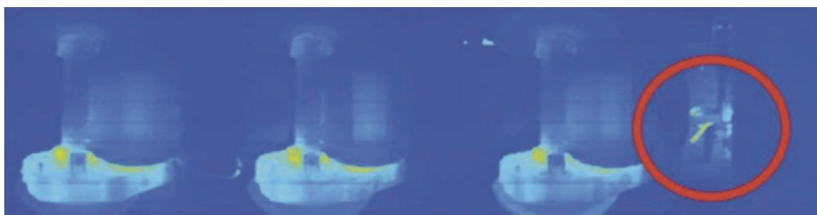
Рис. 1. Изображение трех тяговых двигателей локомотива, полученное при помощи тепловизионной камеры
